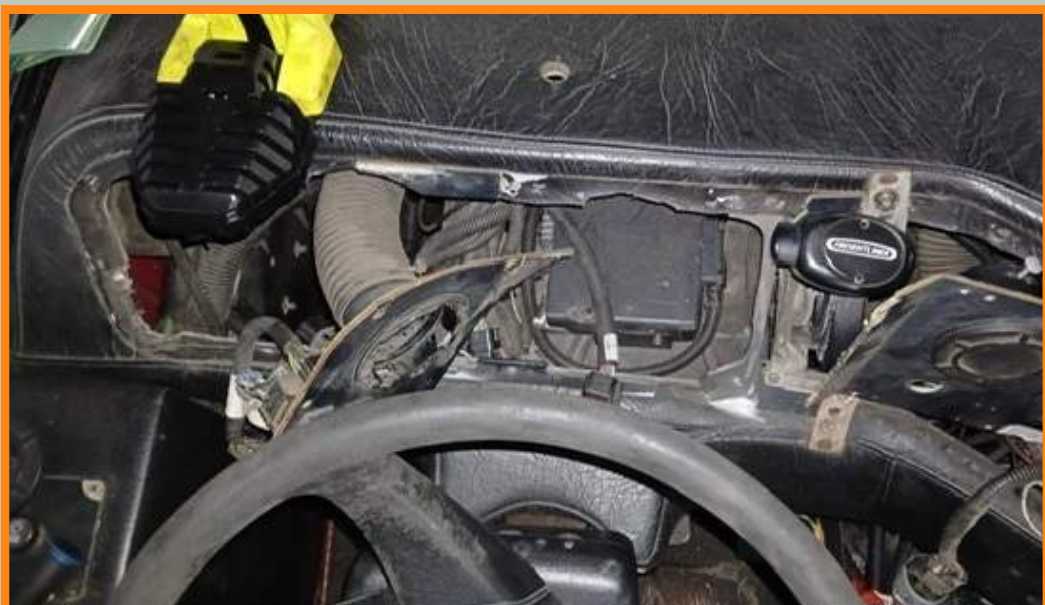
Vista del dash del autobús vintage M-line sin su panel de instrumentos
