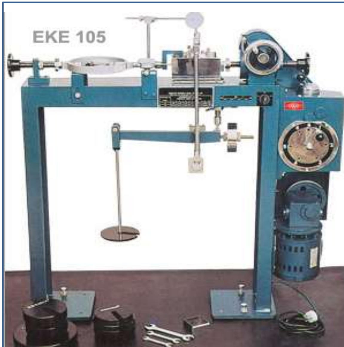
Aparato para Prueba de Corte Directo
