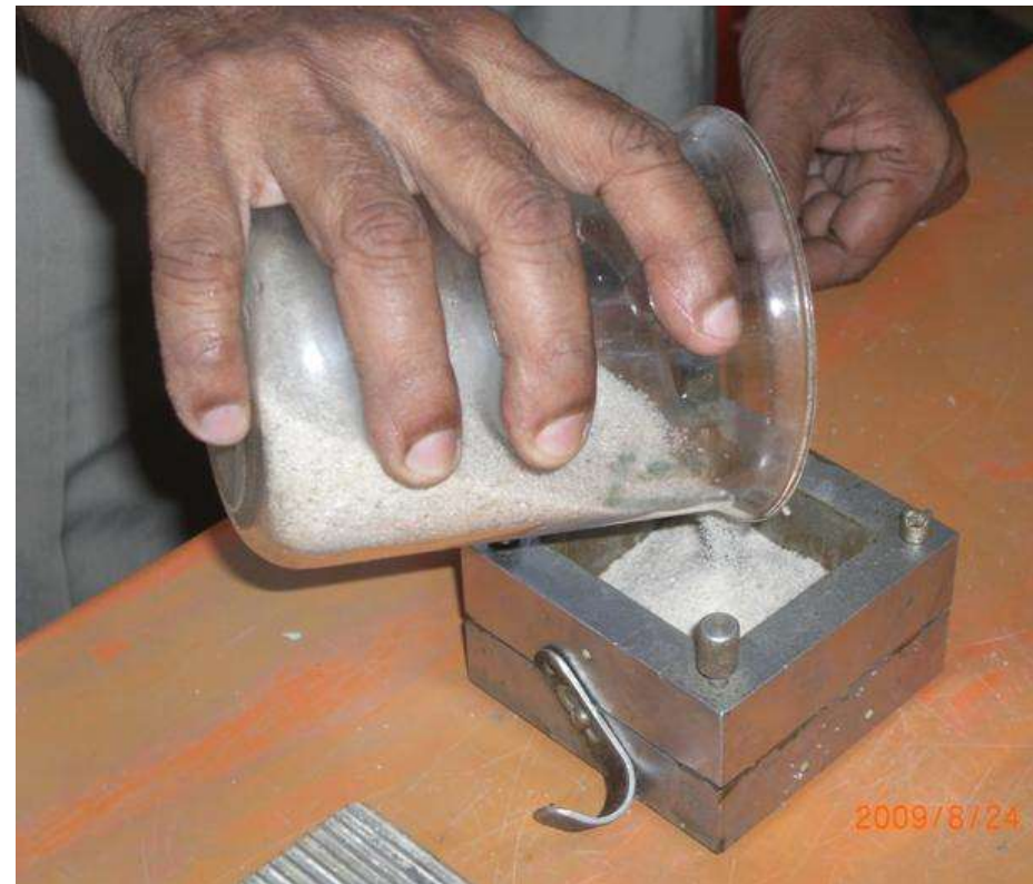
Preparación del espécimen de arena
