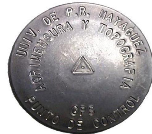
En los vertices del Poligono de Control debe existir una marca Permanente que se denomina PUNTO DE CONTROL, muchos Agrimensores usan varillas de acero.
